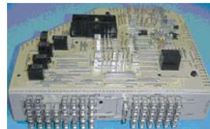
图 4. 在福特 BCM 内部的熔断器连接端口阵列。
