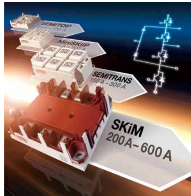
图1：该系列包括10-300 kVA的600V三电平模块，如焊接模块（SEMITOP）、弹簧连接模块（MiniSKiiP）和采用螺丝连接的有铜底板模块（SEMITRANS）及无铜底板模块（SKiM）。
