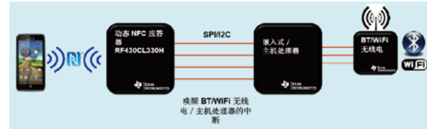
使用动态 NFC 应答器实现与动态标签匹配的简单设置
