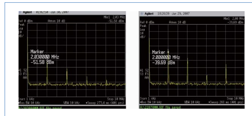
图 4. (a) MIC38300 的 EMI；(b) 普通 2MHz 降压稳压器的 EMI。
