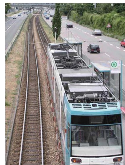
图3. Bombardier的Mitrac Energy Saver火车使用了储能超级电容技术。
