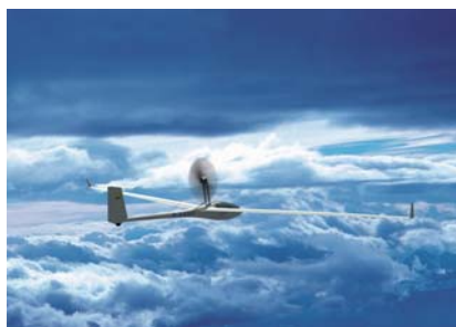
图 1. 爬升中的 Antares 20E 滑翔机。该飞机得益于铰链式挂梁上一个由推进器供电的电机。
