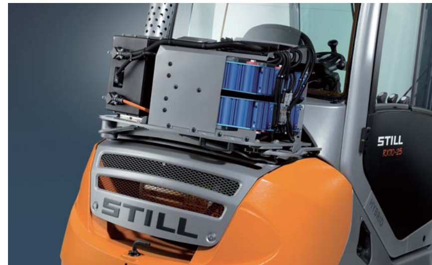
图4. Still的混合动力铲车配备了Maxwell的超级电容模块。
