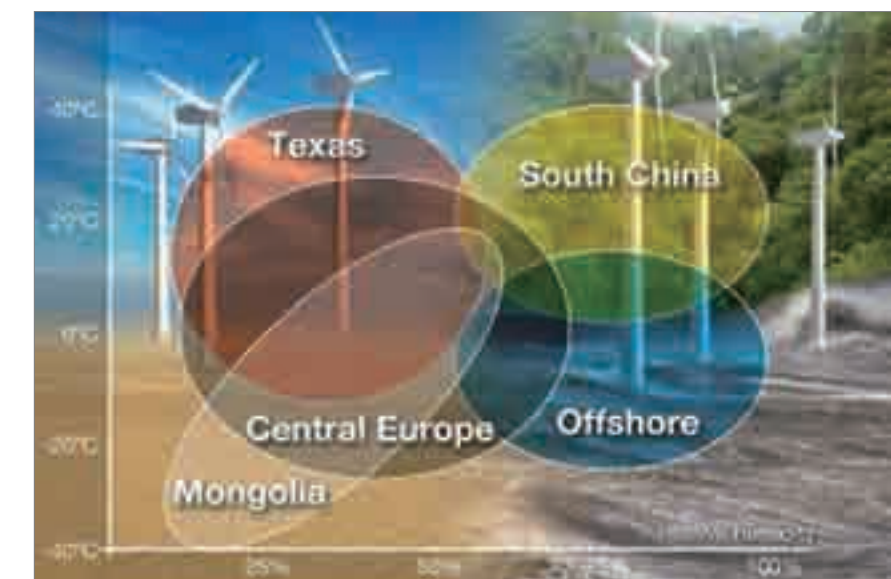
图 1：取决于风力发电机组的预定位置存在不同的气候条件。例如，中国和蒙古的极端气候条件在温度和相对湿度方面是有些矛盾的，这就是为什么这里使用的电力电子系统都必须经过调整，以满足这些非常要求。
