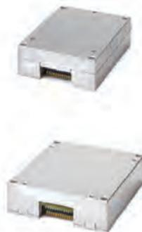
与昂贵的光纤陀螺仪相比, ADIS16136 MEMS 陀螺仪的稳定度和角度随机游走特性与之相当, 线性度则提高 2 倍, 启动时间快 30 倍, 功耗低 5 倍。更重要的是, ADIS16136 陀螺仪的尺寸非常小, 大约为 1 立方英寸, 重量仅有 25 克。相比于 10 立方英寸甚至更大的光纤陀螺仪, ADIS16136 可以说是体积非常的小, 这将有助于许多新应用实现精密角速率检测。
