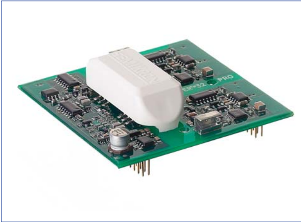
图 3. 在每个模块中都使用 SKYPER 32 PRO 核心驱动器。
