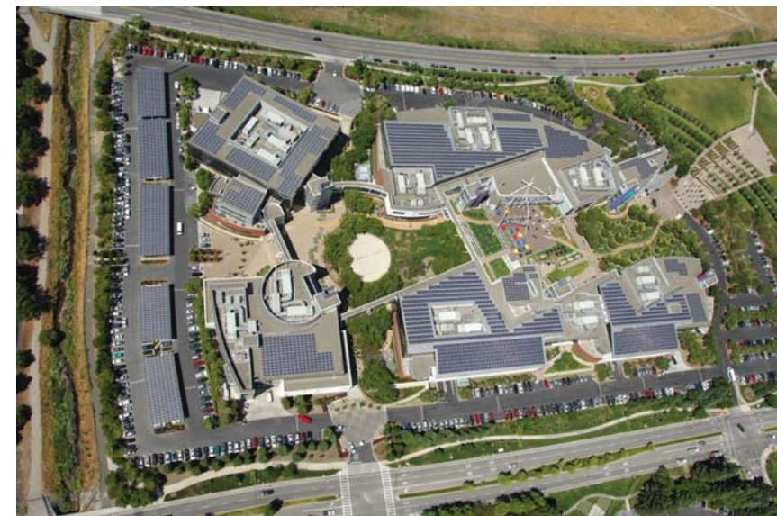
图5. Google公司总部所在地加利福尼亚（从山顶拍摄），建筑顶部安装了新的1.6MW太阳能电池板。
