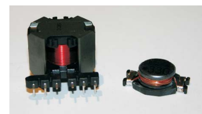
图 2. (a) 47μH 定制电感器，(b) 现成的通用元件。
