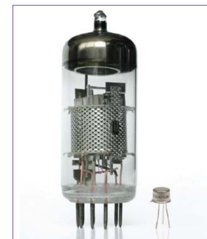
图1. 真空电子管（左）与照晶体管（右）。
