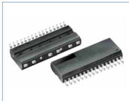
图 4. 采用 SMD 封装的 Motion-SPM™。
