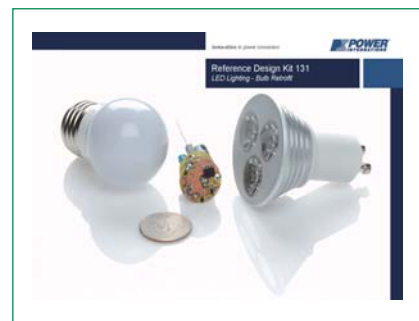
图2. 内置于螺口（E27）或卡口（GU10）插座内的电源。
