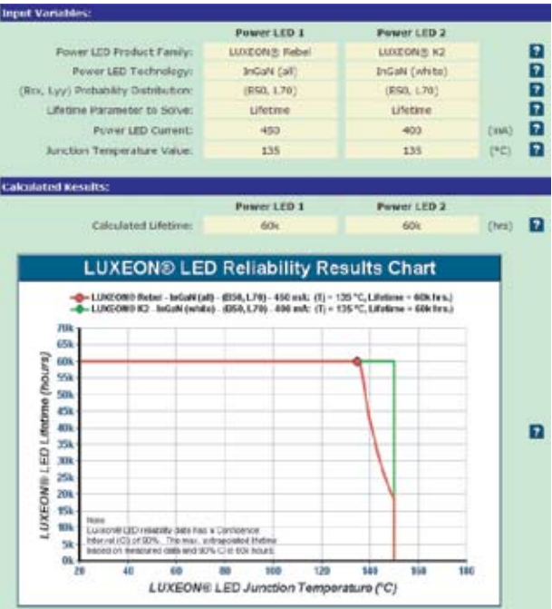
图4. 案例2的LRT可靠性结果。
