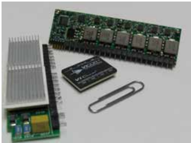
图3: 显示从380V直流配电到点负载供电的标准两级设计实例。左侧是一个由两个400V高压母线转换器组成的板卡, 中间靠近回形针处是单个400V到12V母线转换器, 上方是一个传统的12V降压转换器方案的多相稳压器模块 (VRM)
