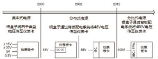
图1：自动测试设备配电架构的发展
