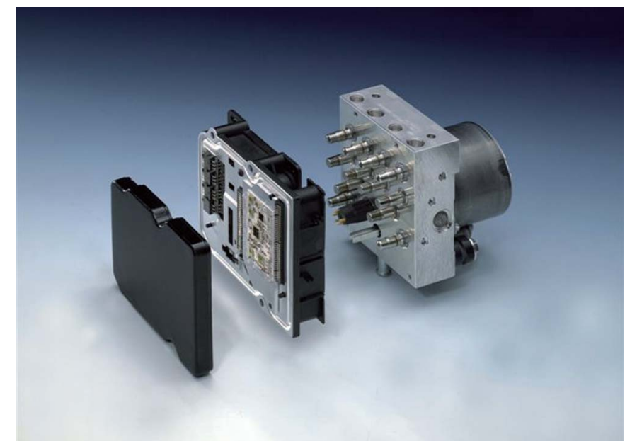
图1. 带混合电路板的ESP®控制系统的部件。（照片来源：博世）
