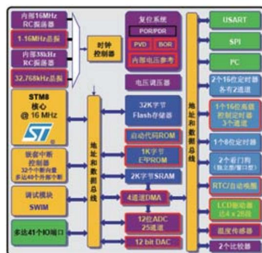
图 4: STM8L152 结构框图。
