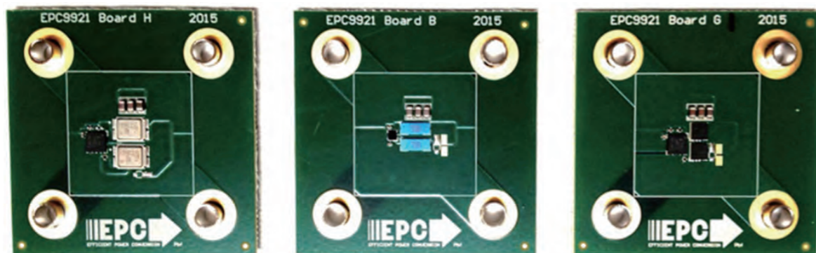
图 5. 48-12 V 测试转换器功率级有 80 V 晶体管：3.7 mΩ CanPAK Si MOSFET (左)，1.8 mΩ eGaN FET (中) 和 S308 Si MOSFET (右)。每块板有 50 毫米的边。
