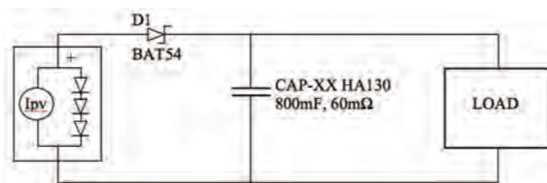
图 2：最简单的超级电容器太阳能电池直接充电电路
