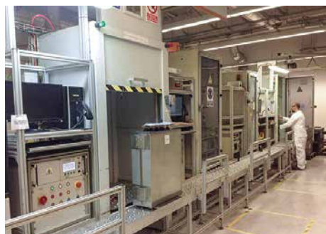
图 4. 图片位于西班牙的 TDK 的马拉加工厂正在生产用于 HVDC 的电力电容器的场景。
